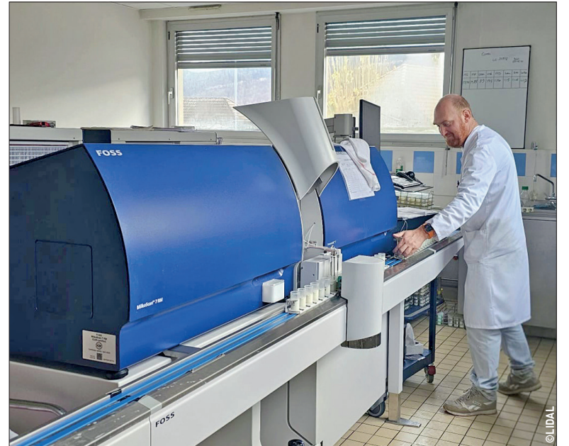
▲ Le nouveau Combi Foss assure l'analyse du lait cru selon 19 paramètres en l'espace de 6 secondes.
