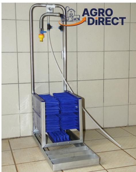
Le lave botte permet le *lavage mécanique des bottes* grâce aux *5 brosses et grattoir*, ainsi que la *désinfection chimique* grâce à son dispositif de mélange et d'injection des produits.
